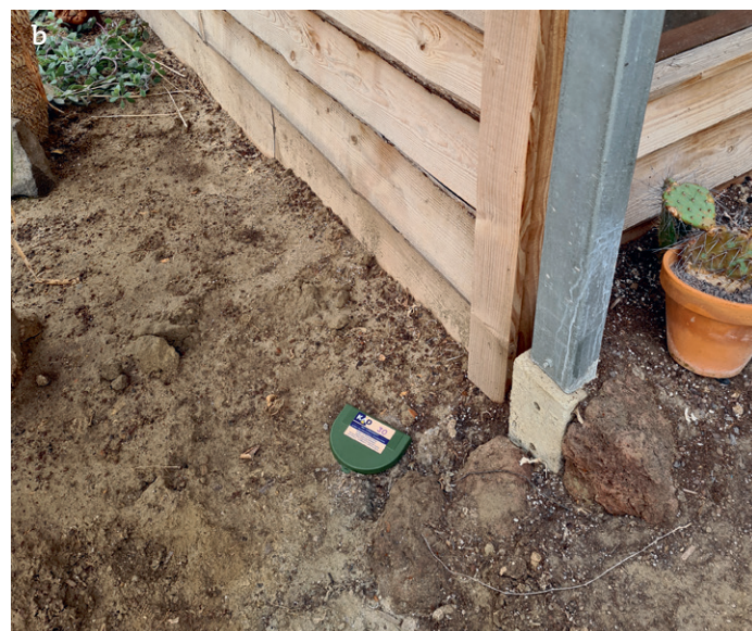
7. (a) Een 'termite monitor' (B&G Equipment Company, VS) in detail. (b) Een geïnstalleerd monitoringspunt op locatie, nabij een potentiële voedselbron. De houten staak is volledig in de grond verzonken onder twee groene kunststof bovenplaten, waartussen een cellulosevel aanwezig is. De termietenactiviteit in het monitoringspunt wordt gecontroleerd door de groene bovenplaat op te tillen en het cellulosevel te inspecteren. Foto's: Vera de Visser (a), Aron Kuiper (b)
