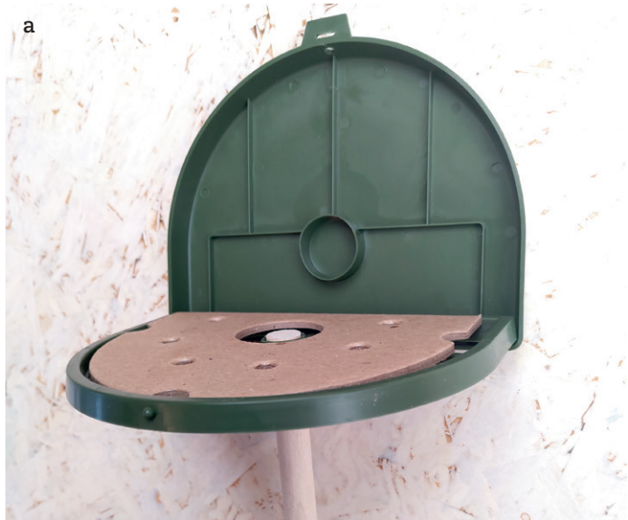
7. (a) Een 'termite monitor' (B&G Equipment Company, VS) in detail. (b) Een geïnstalleerd monitoringspunt op locatie, nabij een potentiële voedselbron. De houten staak is volledig in de grond verzonken onder twee groene kunststof bovenplaten, waartussen een cellulosevel aanwezig is. De termietenactiviteit in het monitoringspunt wordt gecontroleerd door de groene bovenplaat op te tillen en het cellulosevel te inspecteren. Foto's: Vera de Visser (a), Aron Kuiper (b)
